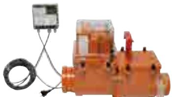
**Typ 3:** Rückstauverschluss für die Verwendung in horizontalen Leitungen mit einem durch Fremdenergie (elektrisch, pneumatisch oder andere) betriebenen selbsttätigen Verschluss und einem Notverschluss, der unabhängig vom selbsttätigen Verschluss ist.
